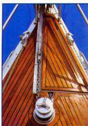
Sotto, la prua con due passacavi e le bitte. C'è la predisposizione per il salpancora elettrico.
