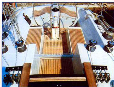
Il pozzetto e la parte della tuga destinata alle manovre. Su quest'ultima si notano i quattro winch e gli stopper dell'equipaggiamento di serie. Ai lati del pozzetto ci sono i due winch per il genoa e i due per lo spi, che però era optional. Le panche sono ricoperte in doghe di teak, il trasto della randa è sul fondo, posto davanti all'ingresso della tuga.
